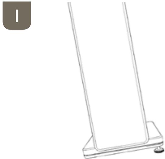
**I** Kippen Sie den Lautsprecher leicht zu einer Seite an. Drehen Sie zwei der vier Füße ein, indem Sie diese in die Gewindelöcher an der Lautsprecherunterseite schrauben. Drehen Sie die Füße vollständig ein und setzen Sie den Lautsprecher vorsichtig ab.
