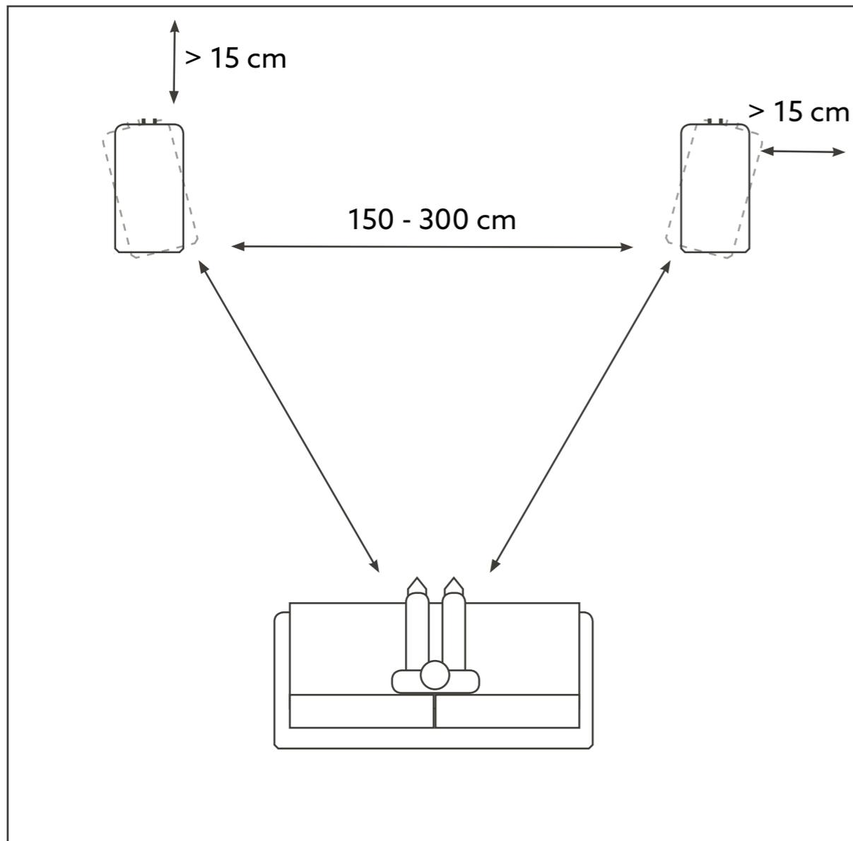
Die Position der den Lautsprecher umgebenden Raumwände hat Einfluss auf den Klang des Lautsprechers. Je mehr Wände und Oberflächen sich in nächster Nähe der Lautsprecher befinden, desto stärker ist die Wirkung der Tiefton- und tiefen Mitteltonfrequenzen.
