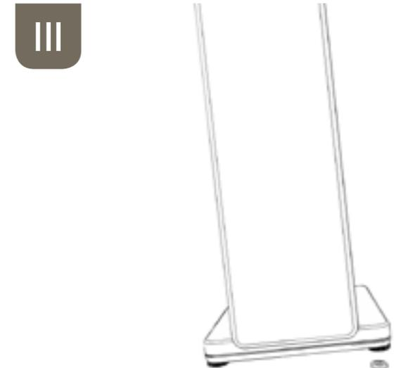
**III** Bei der Nutzung von Rändel-Spikes ist nun der Spike-Teller unter den Spike zu legen, damit der Spike seine Funktion erfüllen kann. Kippen Sie auch hier den Lautsprecher jeweils links und dann rechts an und legen die Spike-Teller mittig unter den Rändel-Spike.
