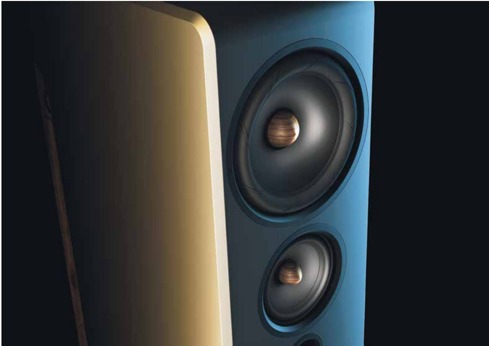
Radien und Fasen ergeben im Zusammenspiel einen überaus eleganten Gesamteindruck. Die Treiber sind allesamt hochkarätig. Hier sehen Sie je einen der Mittel- und Hochtöner, die der Excel-Serie des norwegischen Herstellers SEAS entstammen und für Inklang modifiziert wurden. Optisch auffällig sind die hölzernen Phaseplugs, im Hintergrund sorgen FEA-optimierte Magnetsysteme für linearen Antrieb.
