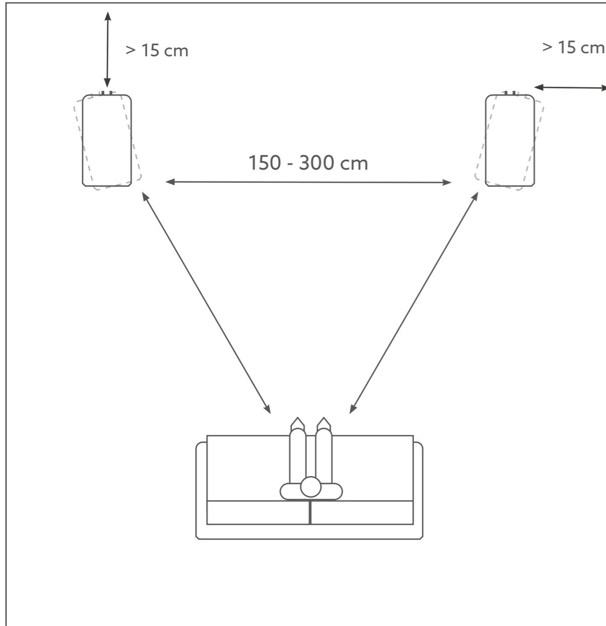
Die Position der den Lautsprecher umgebenden Raumwände hat Einfluss auf den Klang des Lautspeakers. Je mehr Wände und Oberflächen sich in nächster Nähe der Lautsprecher befinden, desto stärker ist die Wirkung der Tiefton- und tiefen Mitteltonfrequenzen.
